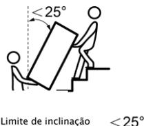
Fig. 3.2-1 Diagrama de transporte da unidade
