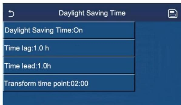
Por exemplo, se 30 de março for o último domingo deste mês, quando o relógio do sistema for para 30 de março, 2h, o relógio do sistema será atrasado automaticamente por uma hora. Ou seja, a hora do sistema exibida passará a ser 30 de março, 3h.
