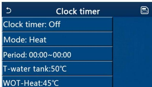
3. A opção “**Mode**” (modo funcionamento) é utilizada para programar o modo de funcionamento desejado; “**WOT-Heat**” e “**T-water tank**” são usados para definir a temperatura da água correspondente (modo aquecimento e modo produção água sanitária); “**Period**” (período) é usado para definir o período de tempo de funcionamento. Depois disso, ao pressionar no ícone “**Save**” (guardar), todas as configurações serão guardadas.
