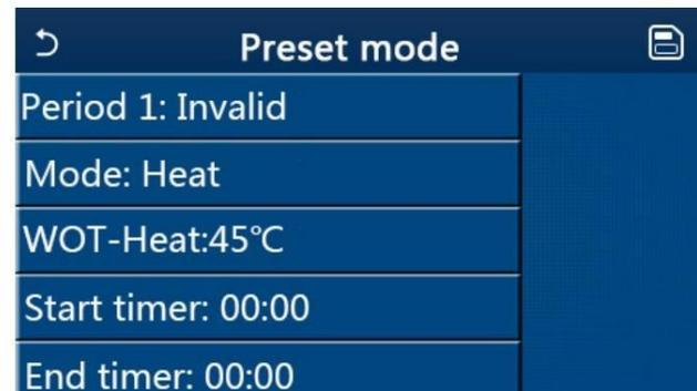
A opção “**Mode**” (modo de funcionamento) é usada para predefinir o modo; “**WOT-Heat**” é usado para definir a temperatura de saída da água fria / quente; “**Start timer**” (horário de início) / “**End timer**” (horário de fim) é usado para definir o horário. Depois disso, ao pressionar no ícone “Save” (guardar), todas as configurações serão guardadas.
